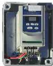
INVERTER CON COMANDO A PULSANTE SINGOLO
